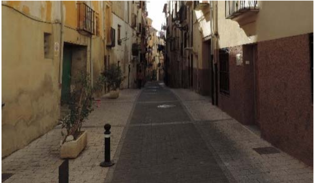
IMAGEN 5.3.7-b: JARDINERAS Y BOLARDOS QUE DIFICULTAN LA ACCESIBILIDAD
